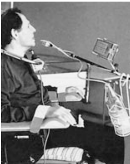
22 Un sistema electrónico de control del entorno dirigido por un palpador lingual permite que esta persona tetrapléjica C5 accione, a distancia, numerosos aparatos eléctricos (timbre, televisión, teléfono, video, persianas automáticas, etc.). También se coloca cerca de la cabeza, donde están concentrados los movimientos residuales, una boquilla para beber y un mando en la barbilla para la silla de ruedas electrónica. El ergoterapeuta adapta también los brazos de la silla para colocar los miembros superiores en una posición correcta desde el punto de vista ortopédico (foto Kerpape).
